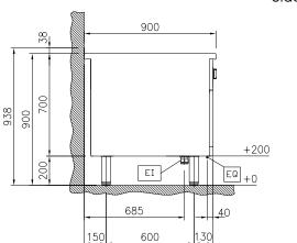
Electrical inlet (power) Equipotential screw ΕI EQ
